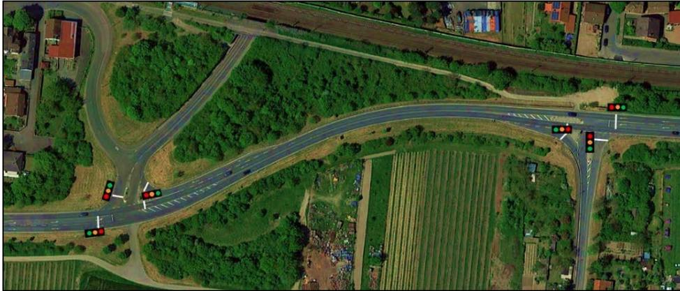
Die Abbildung zeigt die bestehenden Einmündungen der K 53 und der L 439 in die B 9 und in schematischer Darstellung die vom Rechnungshof empfohlene Signalisierung.
