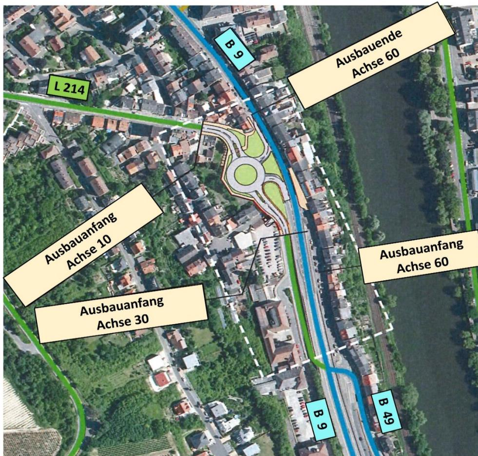
Die vorstehende Abbildung aus dem Planfeststellungsentwurf des Landesbetriebs zeigt den geplanten Umbau des Knotenpunktes B 9/L 214/B 48 in Bingerbrück.
