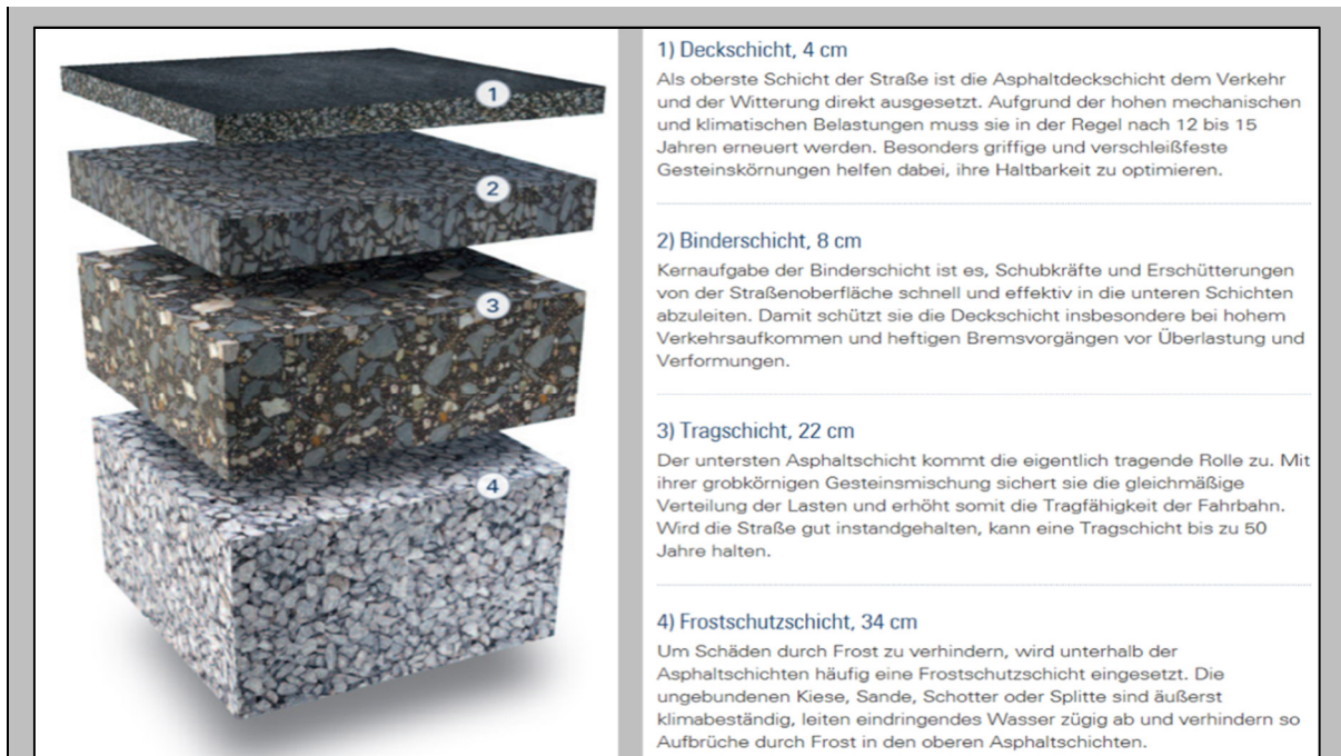
Abb. 8 Aufbau einer Straße 66 - schematische Darstellung -
