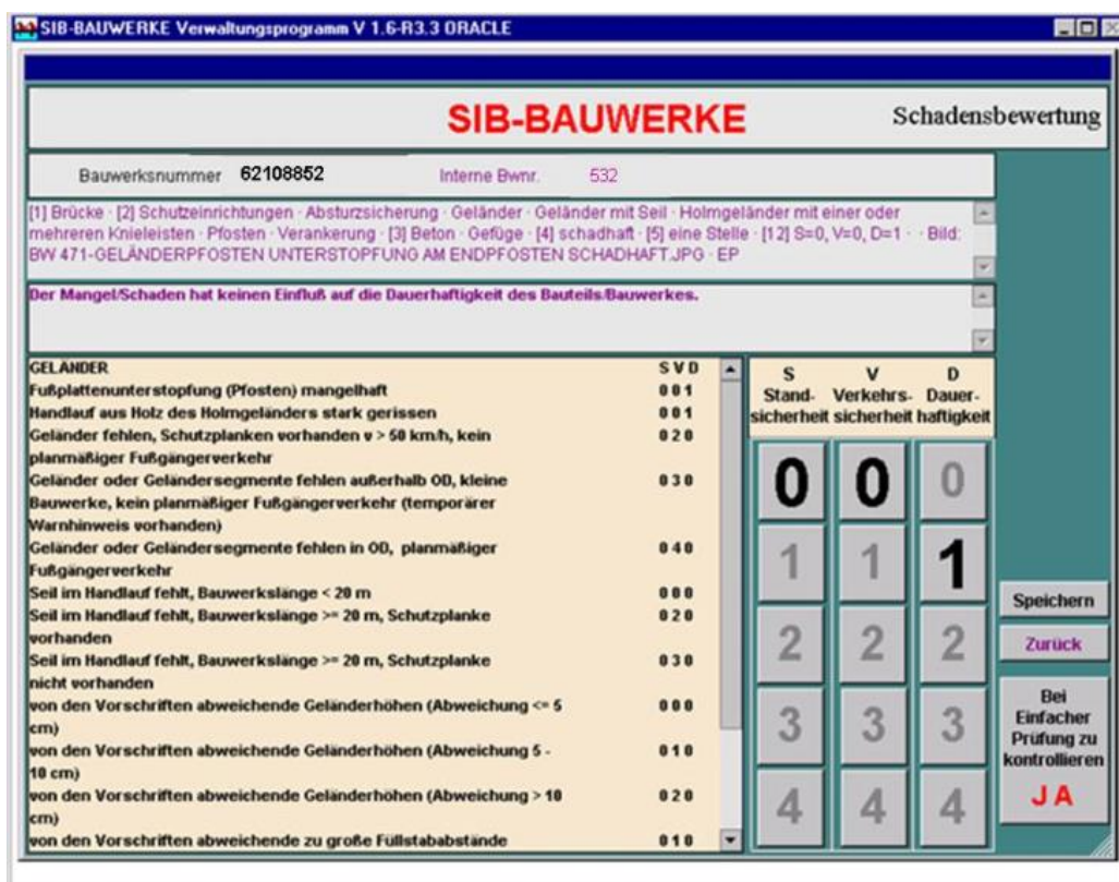
Abbildung 4: Dreistufige Schadensbewertung in SIB-Bauwerke nach RI-EBW-PRÜF
